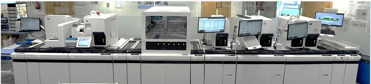
Fig. 15: Cadena Sysmex XN-9100 compuesta por, de derecha a izquierda, de 3 analizadores XN-10; 2 analizadores XN-20; un distribuidor TS; 1 extensor-teñidor SP-50 y un Cellavision® DI-60
